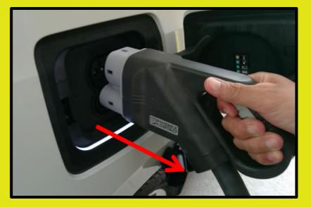
如使用 IEC Type 2 AC 或 CCS 制式的連接器,當充電停止後,使用者可能需要按下電動車上的特定按鈕從而將連接器解鎖。 當連接器被解鎖後,可把連接器從車端插孔拔出,並妥善地放回快速充電器。
