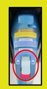
如使用 CHAdeMO 制式的連接器,當充電停止後,請先確保連接器的紅色指示燈已經熄滅,然後將「解鎖按鈕」用力向前推, 直至遮蓋「OK」標示,方可把連接器拔出,並妥善地放回快速充電器。
